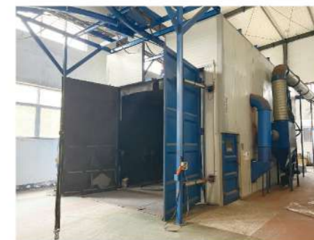
Q26YCCJ 全自动刮板回收式喷砂房
