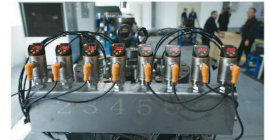
宜昌长机自制静压刀架体测试平台
