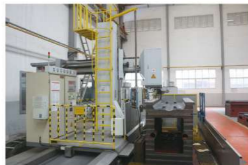
HKHC800CC 超音频数控卧式导轨淬火机床
