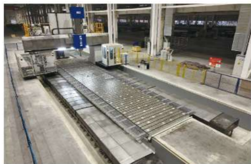
济南二机XK2750×240 数控定梁龙门移动镗铣床
