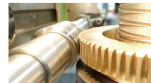
宜昌长机自制 YJ250/500蜗轮副啮合检测仪
